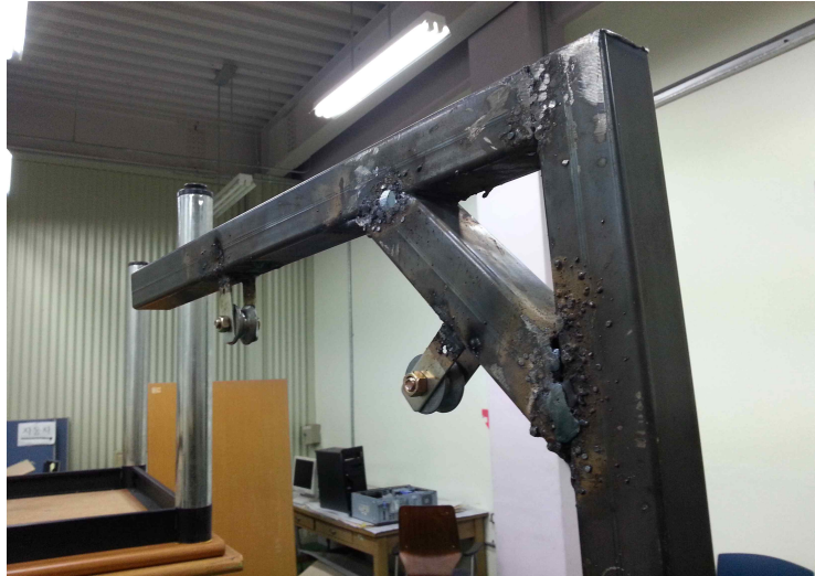
Fig. 3-1-4 지지대 제작 및 도르래 설치
